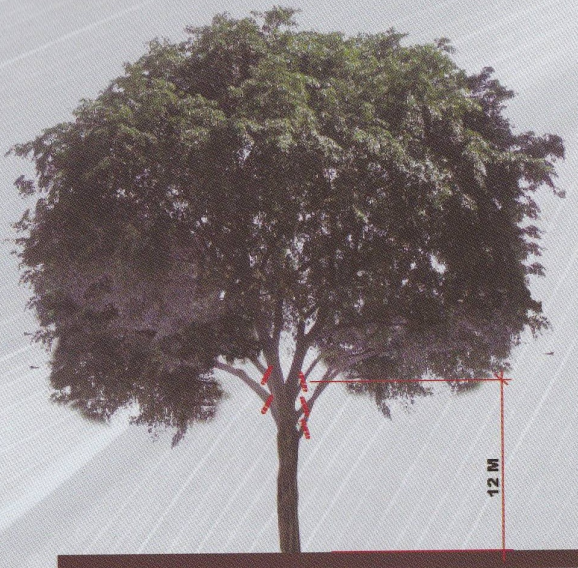
Rajah 3b – mencantas pokok teduhan – pemulihan, dengan minima 5 dahan dipotong pada ketinggian akhir potongan 12 meter.
