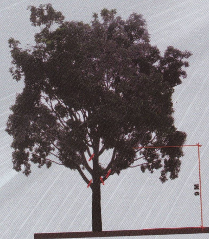
Rajah 2c – mencantas pokok teduhan – berjadual, dengan maksima 4 dahan dipotong pada ketinggian akhir potongan 9 meter.
